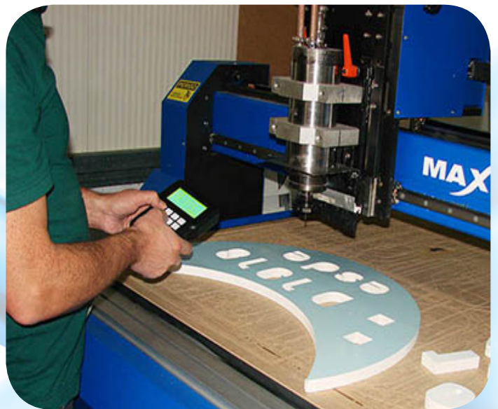
Contrôlée numériquement, la fraiseuse permet de produire des lettres et d'autres pièces en trois dimensions.
