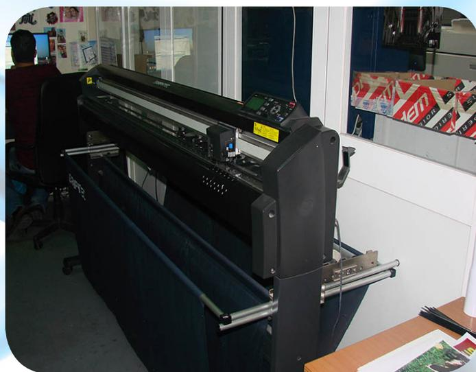
*Plotter de corte: uma lâmina comandada por computador leva a cabo os cortes e vincos num autocolante.*
